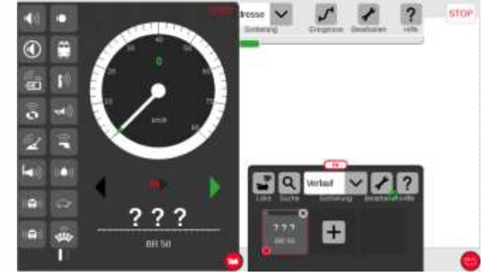
En glissant vers le milieu de l'écran, le pupitre de commande apparaît avec les symboles des fonctions et le tachimètre. La locomotive est prête à être conduite avec le régulateur de marche.
